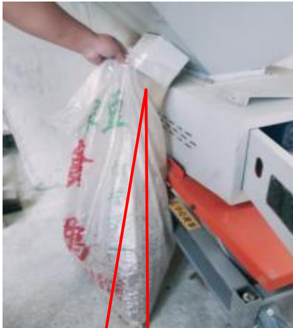
撤除贮料箱 内燃料
