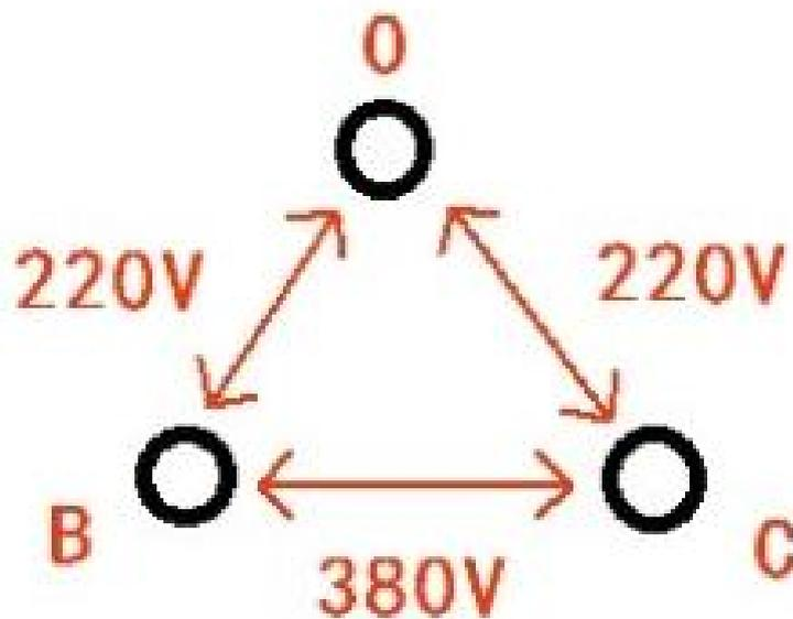
4、把档位打在交流档，量程选择大于所测电压或选择交流档最大量程。分别测试 A, B, C 对中性线的电压，一般是 200-240V，哪相没有就是哪相缺了，**但要注意输入的电压有可能将两相从原输入的一条相线接入的可能，这样实际缺相了但通过相线对中性线脚测不出来。**要是没有中性线的三线都是相线的，就分别测试 AB, AC, BC. 看电压是否在 380V 上下，那个 2 次测试电压过低或没电压就能判断出哪一相缺相。例：AB 电压低而 AC 电压高，其中的 B 就可能是缺相的，再测 BC 也会是电压低就能确定是 B 相缺相。
