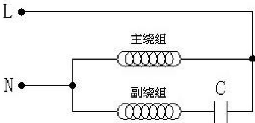
电容起动式：这种电动机是在副绕组上串接一个电容器和一个离心开关后再与主绕组并联，电容器在电动机起动时有电通过，待电动机转速达到其额定转速的70%左右，由于转子在运转时产生离心力作用，把离心开关断开，切断了通过电容器的电源，单独由主绕组工作，所以这种电动机称为电容起动式电动机。
